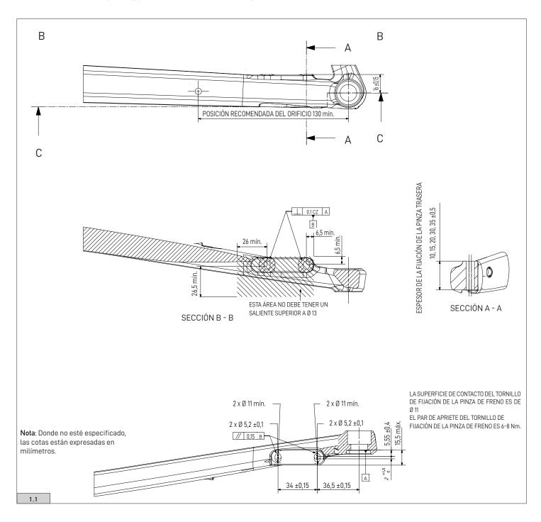
• Compruebe con la fresa del cuadro que la superficie de apoyo de las pinzas en la horquilla y en la vaina inferior izquierda esté perpendicular a los discos. Si es necesario, frese el cuadro para lograr esta condición (Fig. 2).
