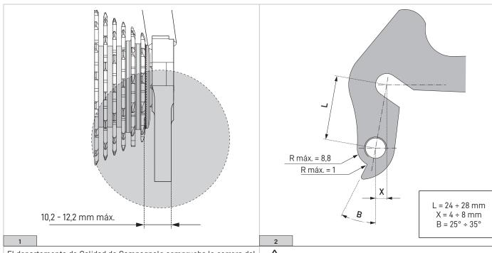
El departamento de Calidad de Campagnolo comprueba la carrera del balancín en función de la tracción del cable en cada una de las piezas fabricadas. La distancia entre el enganche del cambio y el primer piñón influye en esta carrera, por lo que es fundamental respetar la tolerancia prescrita en el dibujo (Fig. 1).
