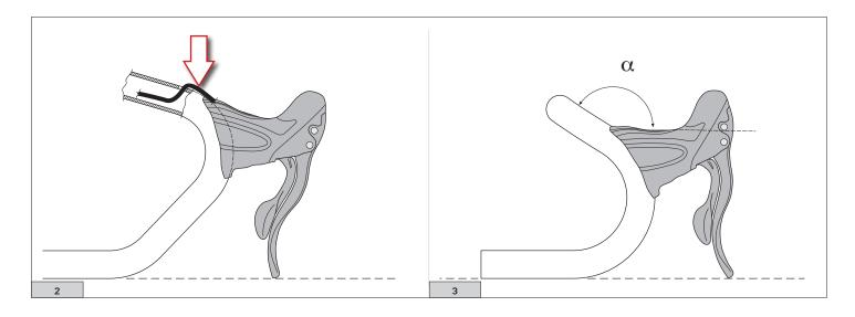
ADVERTENCIA: Los pasos del cable del tipo indicado en la figura 2 comprometen gravemente las prestaciones de cambio y desvío de la transmisión.
