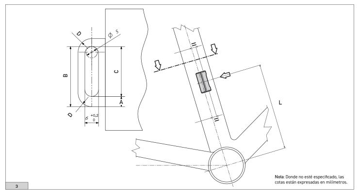
Para la compatibilidad con todos los engranajes indicados en la tabla 1, es necesario respetar las siguientes medidas: C: valor mínimo 22 mm (C > 22 mm) - B: valor máximo 27 mm (B < 27 mm) - A: valor máximo 5 mm.
