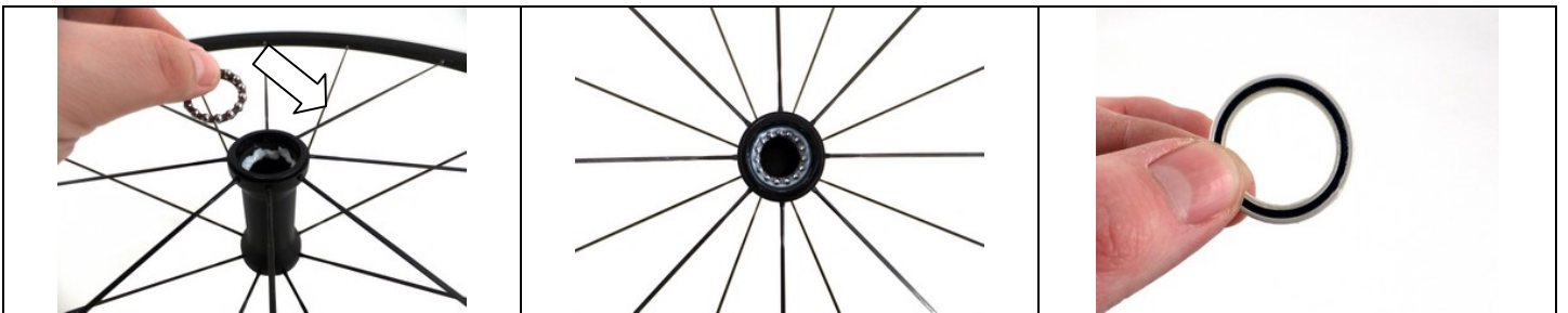
58 Den Kugelkäfig in den Nabenkörper einführen. 59 Den Käfig auf dem Sitz der Lagerschale auflagern. 60 Der Dichtring muss unversehrt sein; anderenfalls wird er ausgewechselt.
