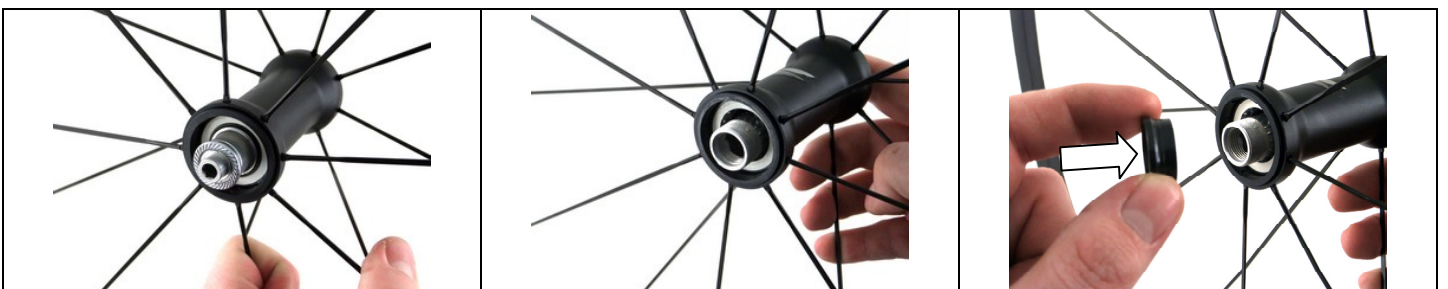
67 Die korrekte Positionierung des Konus auf dem Kugelkäfig prüfen. 68 Die Nabe um 180° drehen. 69 Den Konus auf die Nabenachse setzen; dabei die korrekte Richtung einhalten. Der größere Durchmesser muss zur Außenseite des Nabenkörpers weisen.
