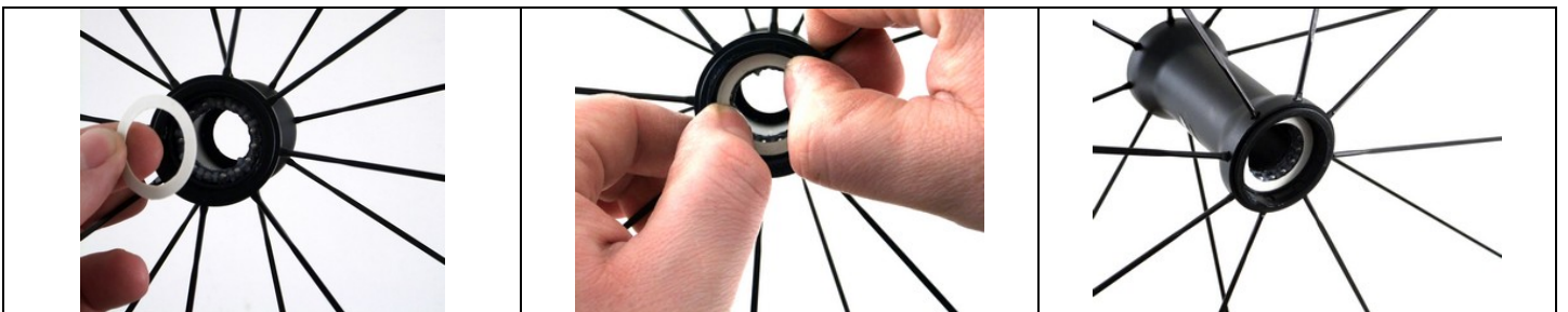
61 Der schwarze Teil der Dichtung muss zum Inneren des Nabenkörpers gerichtet sein. 62 Den Dichtring in den Nabenkörper einführen. 63 Den Eingriff auf der gegenüberliegenden Seite wiederholen (von 62 bis 68).
