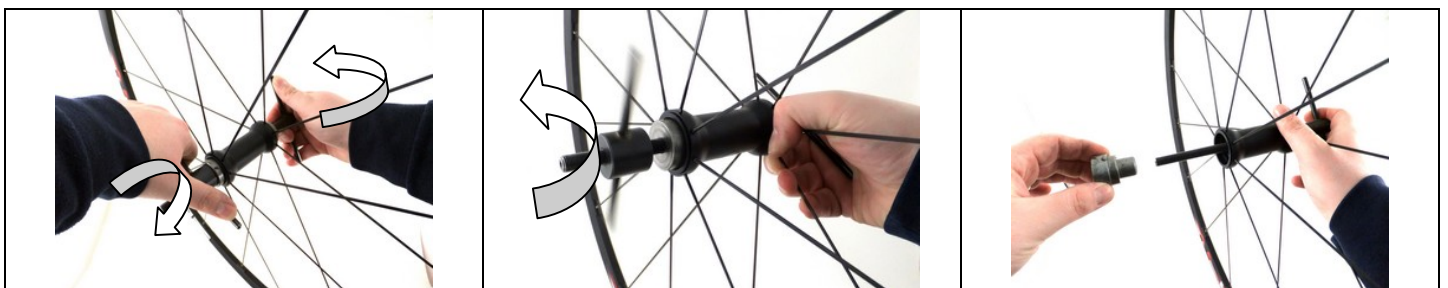
52 Chiudere con forza le due maniglie dell'attrezzo fino al completo piantaggio delle calotte. 53 Svitare l'inserto filettato. 54 Rimuovere il posaggio della calotta.
