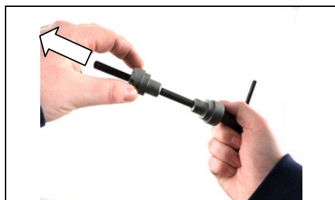
43 Sfilare il posaggio mobile.
