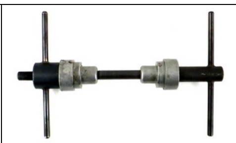
41 Usare l'apposito attrezzo per il piantaggio delle calotte.
