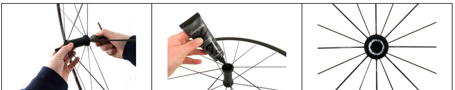
55 Rimuovere l'attrezzo per piantaggio calotte. 56 Ingrassate la superficie della pista sfere della calotta utilizzando grasso specifico per cuscinetti. 57 La quantità di grasso inserita deve coprire circa il 75% dello spazio libero tra sfere e calotte.
