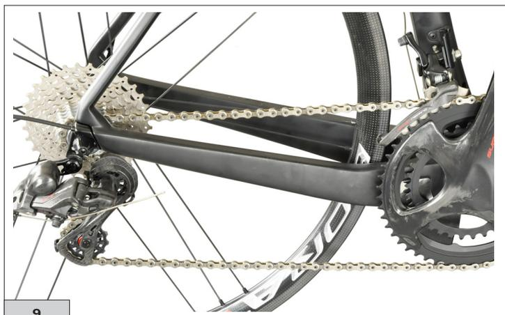
**10)** Gire el tornillo de fin de carrera externo (Fig. 10) hasta que la semihorquilla externa esté a una distancia de 0,5 mm de la cadena (Fig. 10).
