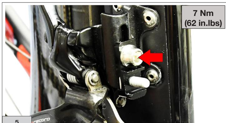
6) Después de haber bloqueado el desviador, compruebe que la patilla siga apoyada en la herramienta y que el borde exterior esté paralelo a la línea blanca (Fig. 6).
