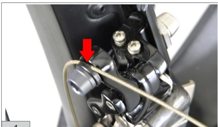
5) Compruebe que el diente de la arandela de fijación se sitúe en la ranura de la biela del desviador en el lado interno (Fig.5).
