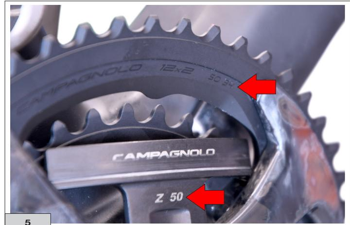
3) Instale la herramienta en el engranaje más grande manteniendo la biela en posición casi horizontal, de modo que los dientes de mayor longitud se apoyen en el fondo de la ranura de la herramienta (Fig. 6).
