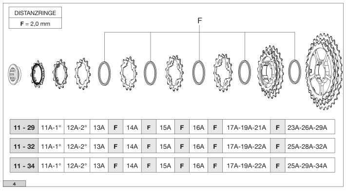
Achten Sie darauf, dass Sie die genaue Montagereihenfolge der Distanzringe einhalten (Abb. 4).
