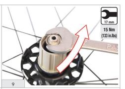
Appliquer une clé fixe de 17 mm à droite de l'axe et visser l'écrou en serrant à un couple de 15 Nm (133 in.lbs) (Attention! L'écrou a un filetage à gauche).
