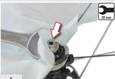
Introduire, sur la bague de réglage, une clé fixe de 20 mm, en la protégeant avec du papier d'atelier pour ne pas la rayer.
