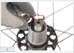
Introduire l'entretoise et visser l'écrou (Attention ! L'écrou a un filetage à gauche).
