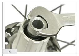
Dévissez l'écrou du corps de roue libre. Attention, filetage à gauche!
