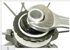
Verrouillez l'axe avec une clé plate de 14 mm.
