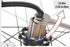
Introduire l'outil (UT-WHDB001 ou UT-WHDB002) à droite de l'axe et, à l'aide d'une clé Spanner de 18 mm, serrer à un couple de **15 Nm (133 in.lbs)**.
