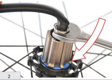
À l'aide d'une clé Spanner de 18 mm, dévisser l'écrou (Attention! L'écrou a un filetage à gauche ) puis, sortir l'écrou et l'entretoise.
