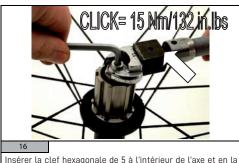
Insérer la clef hexagonale de 5 à l'intérieur de l'axe et en la maintenant fixe, visser le contre-écrou avec la clef dynamométrique de 17.
