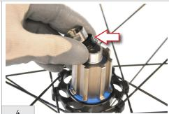
Introduire l'entretoise et visser l'écrou (Attention! L'écrou a un filetage à gauche).
